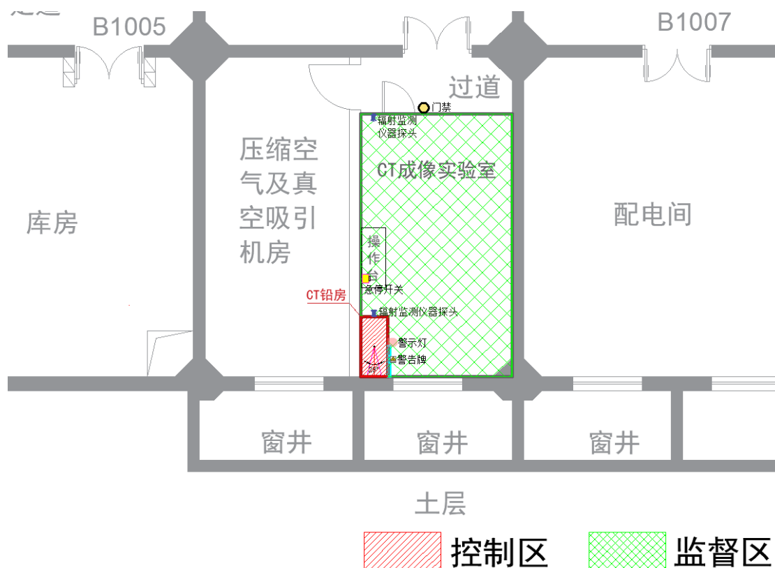
图 10-1 CT 铅房联锁和安全措施布置图
